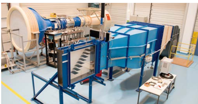
TurboLab des Fachgebiets mit dem Axialverdichter-Prüfstand und Aeroelastik-Windkanal
